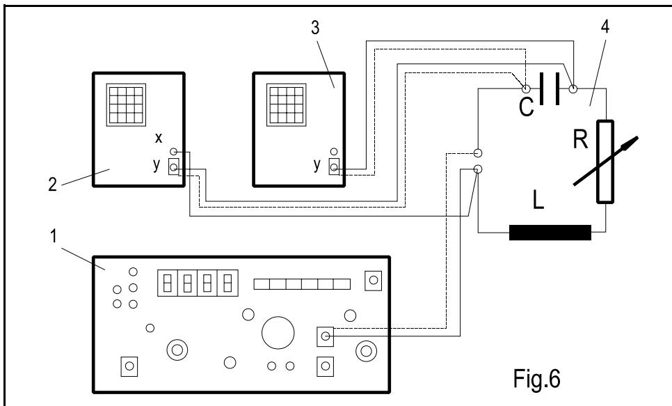
1 - generator de semnal sinusoidal tip VERSATESTER E 0502
